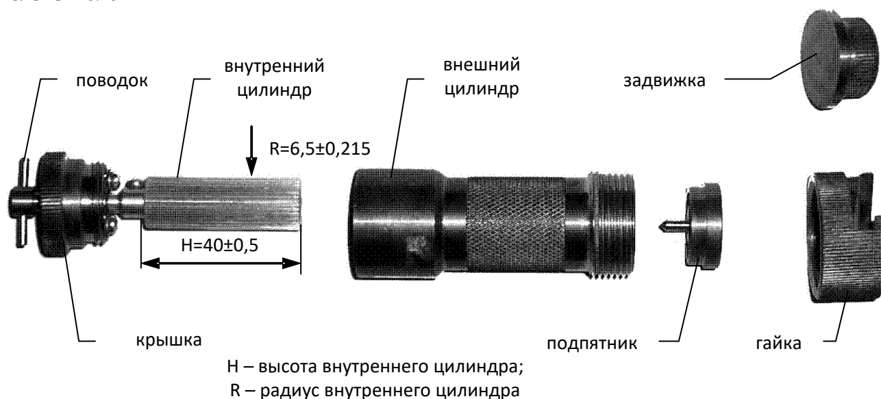
Рисунок 3 – Элементы датчика
